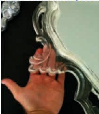
Una nuova resina trasparente da colata, assolutamente **NON INGIALLENTE** utilizzata per colate in stampi rigidi, con ausilio di cera gloss, o in stampi di gomma silconica. Adatta per colate ad alto spessore su superfici in piano o per inglobamenti. Questa nuova resina **NON INGIALLISCE MAI** e non scalda in fase di indurimento come le altre resine.
