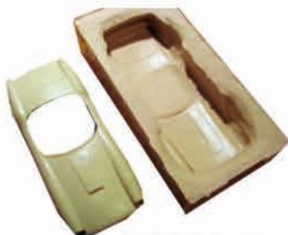
Può essere addizionata con OLIO DI SILICONE PROCHIMA fino al 5% in peso senza avere una sensibile riduzione della durezza e senza peggioramento delle capacità meccaniche.
