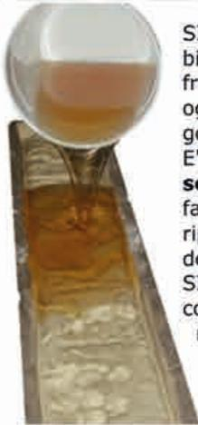
SINTAFOAM è un formulato poliuretano bicomponente molto fluido, che indurisce a freddo. Viene impiegato per riprodurre piccoli oggetti, prototipi per colata in stampi in gomma siliconica.
